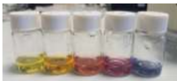
Figura 1. Variedad de color que presenta la disolución de nanopartículas de plata en función de su tamaño. Fotografía propia.
